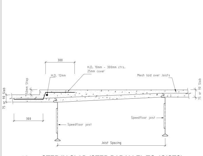
50mm STEP IN SLAB (STEP PARALLEL TO JOISTS)
